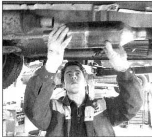
Auf die richtige Technik kommt es an: Einbau eines Rußfilters. Foto: Hoff
